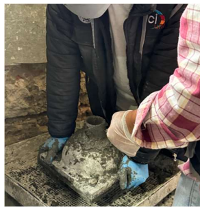
Figura 21. Sosteniendo el molde mientras se hace el vibrado
