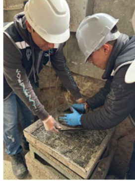
Figura 13. Vaciado de la mezcla en la mitad del molde
