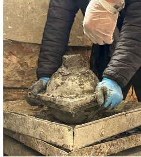
Figura 24. Sosteniendo el molde para el vibrado de la mesa
