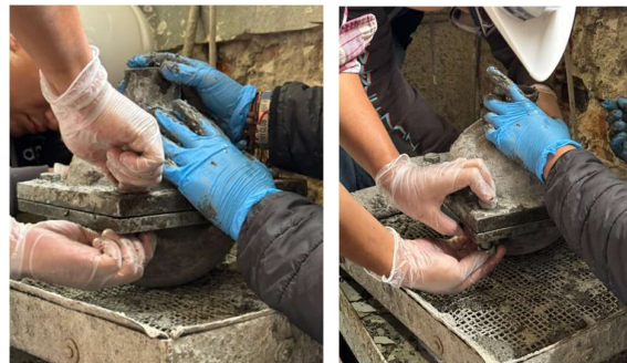
Figura 18. Colocación de pernos en molde
