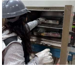
Figura 3. Retiro de las bandejas de perlitas del horno
